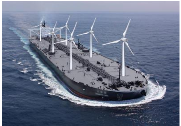
図 7-10 オートジャイロプロペラ揚力発生装置を備えた船舶
